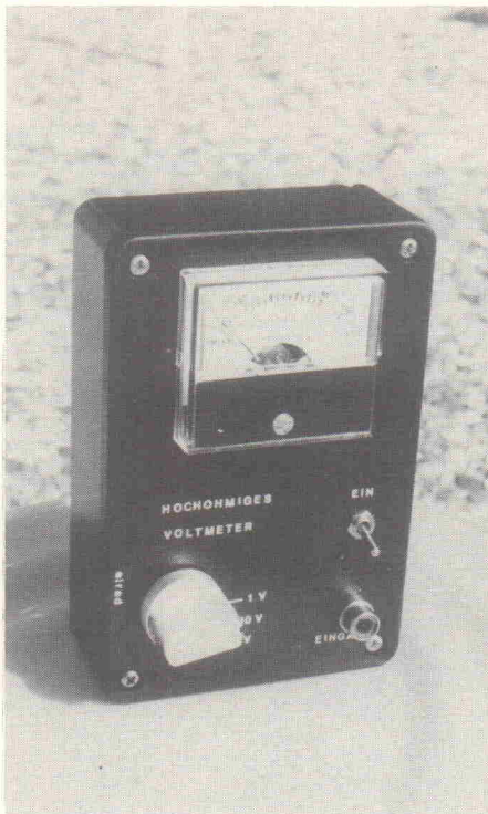
Das Voltmeter eingebaut in ein kleines Plastikgehäuse
